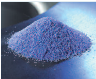
Corindone sinterizzato microcristallino Sigla breve: EB oppure EX
